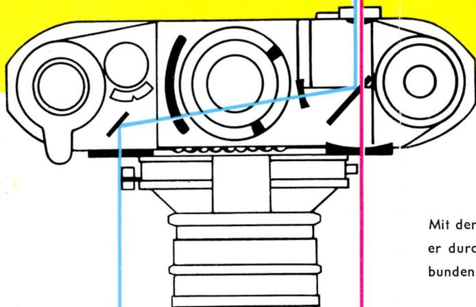
des LORDOMAT vereinigt in einem einzigen Okular Sucher und Entfernungsmesser. Er ermöglicht eine sehr schnelle Scharfeinstellung und ist auf Grund seiner großen Meßbasis äußerst genau.
