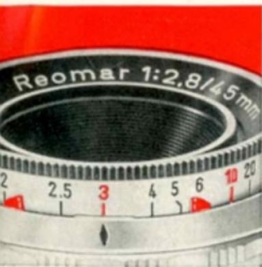
sofort abzulesen. Wenn Sie den Verschlußring drehen, bewegen sich die beiden roten Zeiger des automatischen Schärfenbereichs-Anzeigers auf der Entfernungsskala. Die beiden **roten Zahlen** (3 und 10) auf der Entfernungsskala sind Anhaltspunkte für Schnappschuß-Aufnahmen. Bei nahen Objekten stellen Sie die Entfernung auf die rote 3, bei weiter entfernten Objekten auf die rote 10 ein. An der Stellung der beiden roten Zeiger können Sie den jeweiligen Schärfenbereich sofort ablesen.
